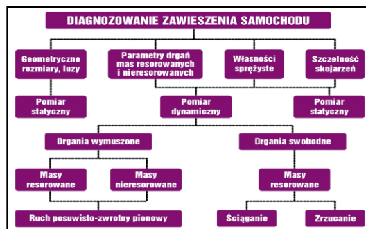
Klasyfikacja parametrów diagnostycznych i metod diagnozowania układu zawieszenia
