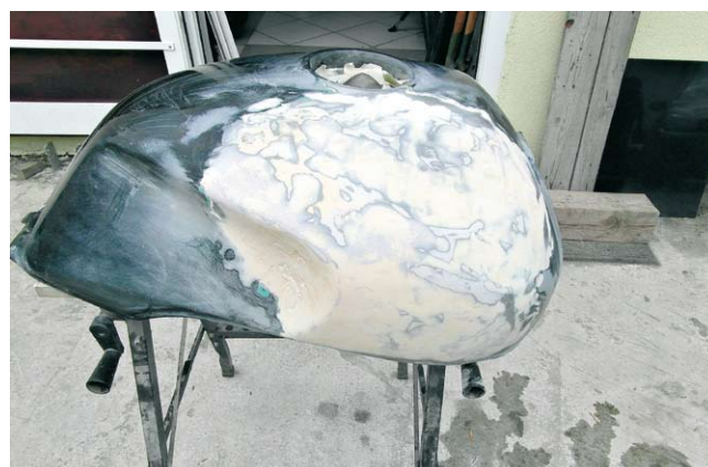
Niedoskonałości powierzchni zbiornika paliwa korygowane metodą szpachlowania
