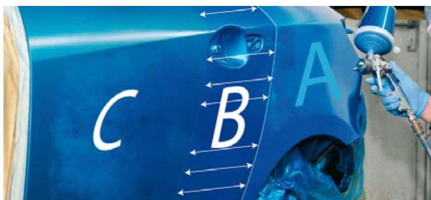
Cieniowanie stosujemy, aby uniknąć widocznych różnic pomiędzy naprawianymi elementami karoserii a pozostałymi, które nie będą pokrywane nową warstwą lakieru
