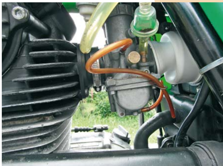
Jednocylindrowy silnik zasilany gaźnikiem klasycznym z centralną komorą pływkową. Widoczne zanieczyszczenia stałe osadzone w zewnętrznym filtrze paliwowym. Takie zanieczyszczenia mogą być przyczyną blokowania zaworu iglicowego pływaka i „przelewania” gaźnika
